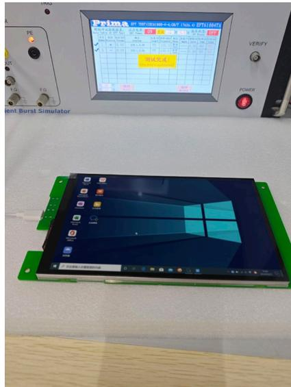
图 4-4 群脉冲测试图
